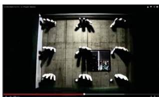
■ 壁面へのプロジェクションマッピング 高輝度プロジェクター2台で投射。メディアサーバーPandras Boxを使用
