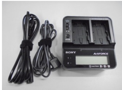
バッテリーチャージャー
