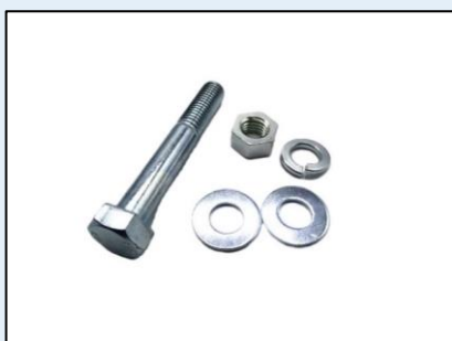
パイプ連結ボルトセット 半ネジボルト M12 80mm×2 ナット×2 平ワッシャー×4 スプリングワッシャー×2
